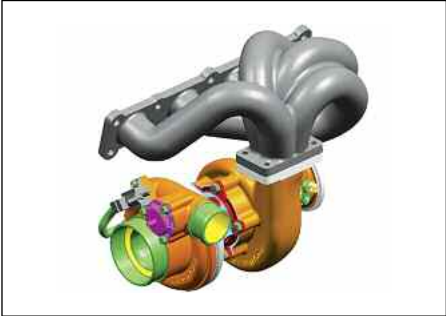
Diseño Cad-Cam de conjunto turbo-múltiple de escape.
