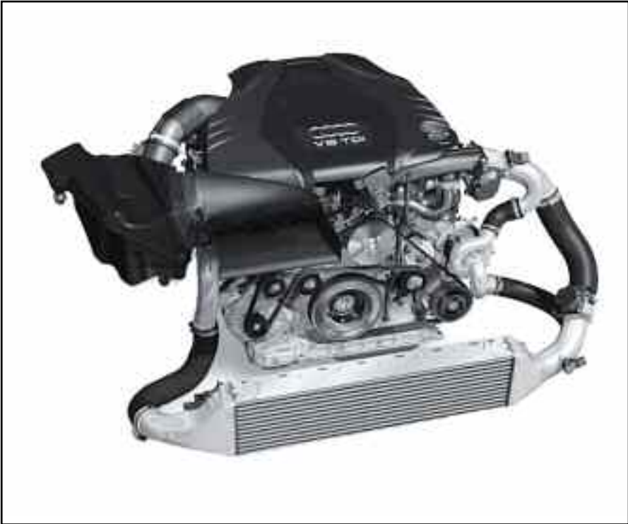
Detalle del intercooler del sistema de sobrealimentación Diesel.
