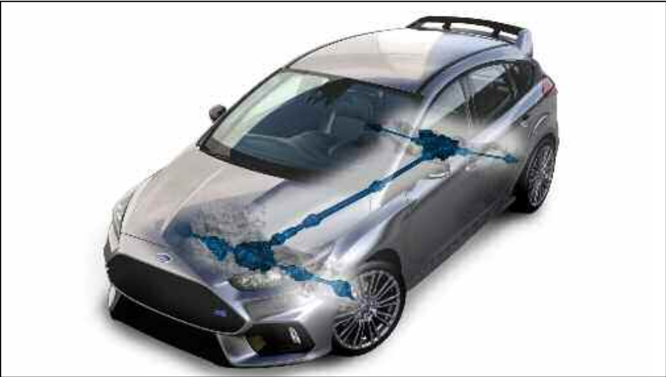
Por primera vez en un Focus RS, el sistema de tracción es en las cuatro ruedas y no tiene nada que ver con el que lleva un Kuga. En función de las condiciones de adherencia, dos embragues (de siete discos) accionados hidráulicamente situados uno a cada lado de salida del diferencial trasero se encargan de repartir el par, tanto en sentido longitudinal —los embragues son movidos por un eje de transmisión que viene del diferencial delantero y que gira solidario, según la información, con el palier delantero derecho— como en sentido transversal en las ruedas traseras.
