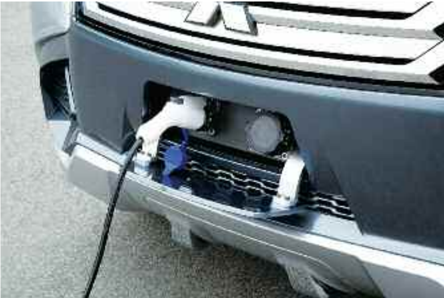
El toma eléctrica CA 100 V a bordo es capaz de ofrecer una fuente de alimentación externa de hasta 1500W de energía eléctrica, ideal para actuar como una fuente de energía de emergencia para electrodomésticos en el caso de un corte de energía. El uso de la energía almacenada en una batería de iones de litio completamente cargada, del concepto de GC-PHEV puede suministrar el equivalente de todo un día de consumo de energía eléctrica para el hogar.
