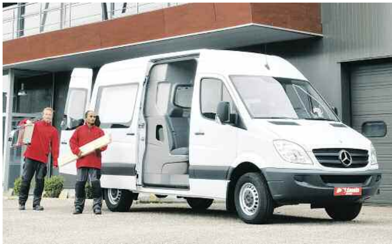
La Sprinter es un vehículo pensado especialmente para el transporte, tanto de mercancías como de pasajeros. Por esta razón el nuevo modelo reduce su altura del plano de carga al suelo en 30 mm. Esto facilita tanto el acceso de los pasajeros, en las versiones carrozadas para estos menesteres, como la carga o descarga.
