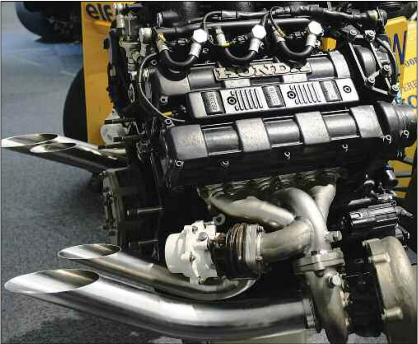
Motor Honda F1 - 1984/88 biturbo de tantos éxitos.
