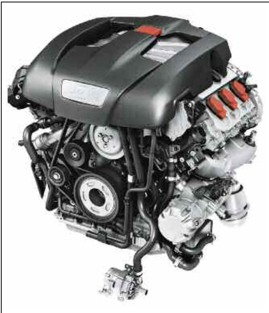
Motor naftero de 3.0 litros, de 6 cilindros en V aplicado en el Porsche M Panamera S Hybrid, (motor térmico combinado con un motor eléctrico).
