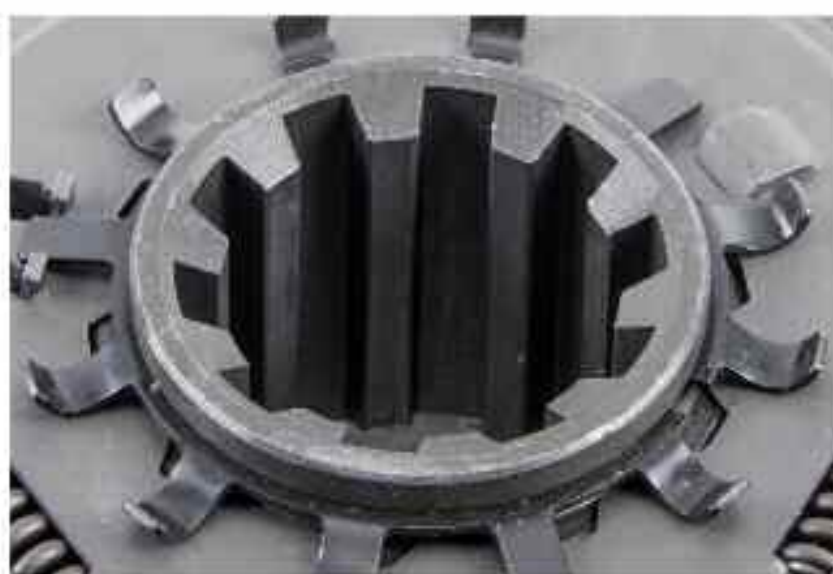
Fig. 2: Los bujes fosfatados deben engrasarse
