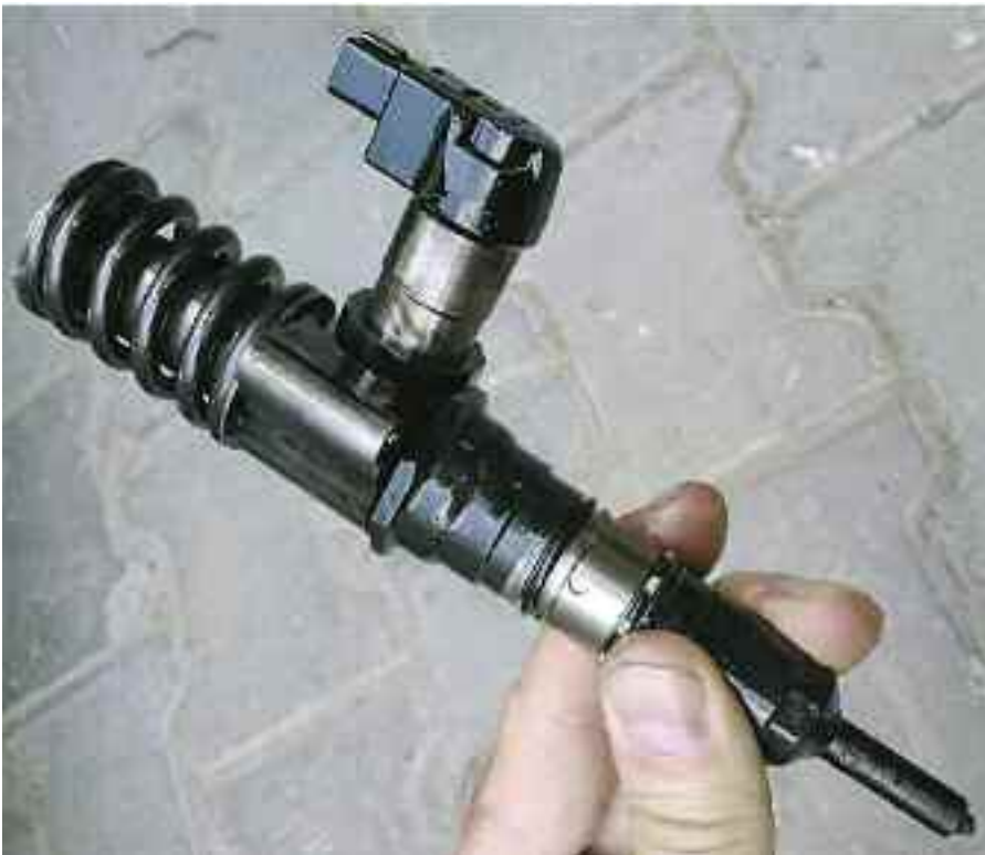
El inyector/bomba reagrupa en un solo cuerpo, una bomba de alta presión, una lectroválvula de comando, y un inyector.
