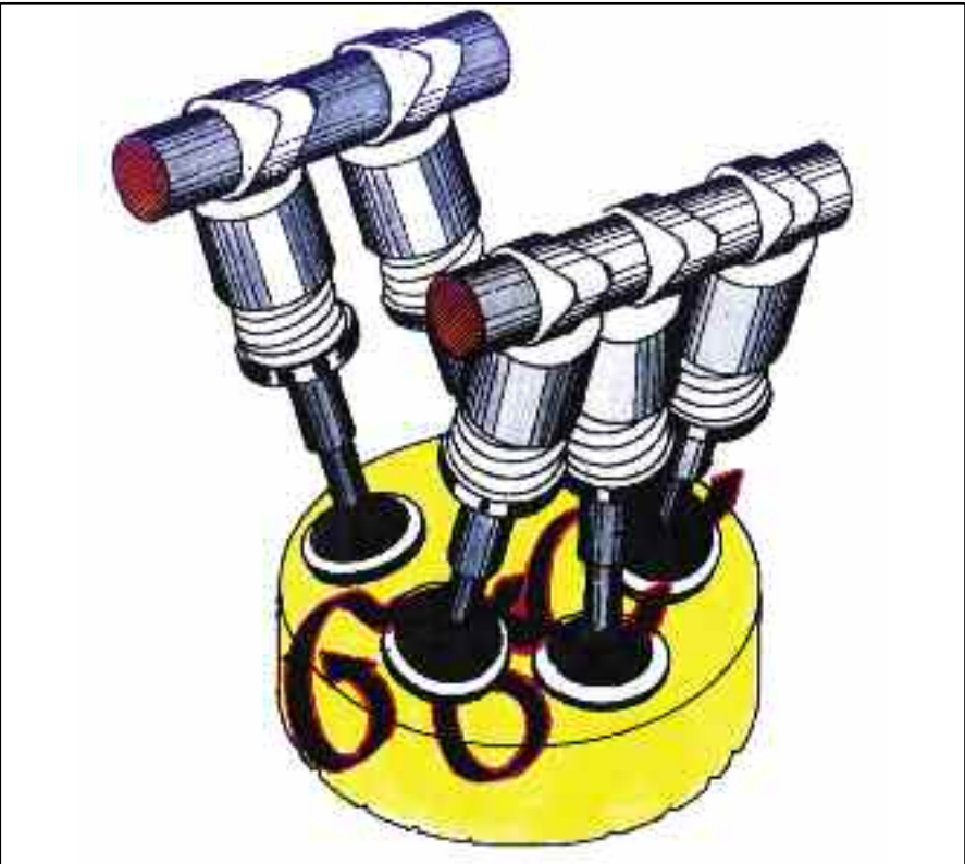
Sistema de distribución con válvulas múltiples, 3 de admisión y 2 de escape.
