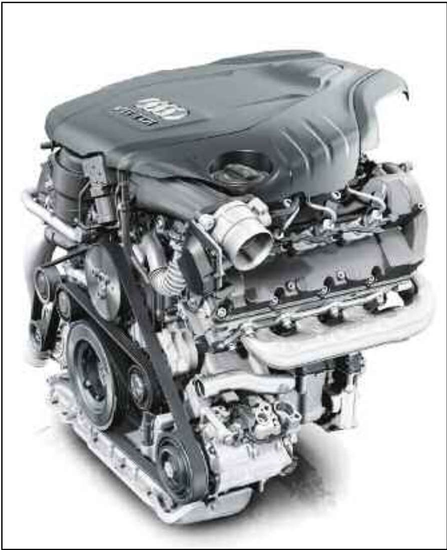
Motor gasolero de 3.0 litros 6 cilindros en V, 4 válvulas por cilindro, con inyección directa "Common rail" de alta presión, con inyectores piezoeléctricos y turbo TGV, controlado por el sistema EDC.
