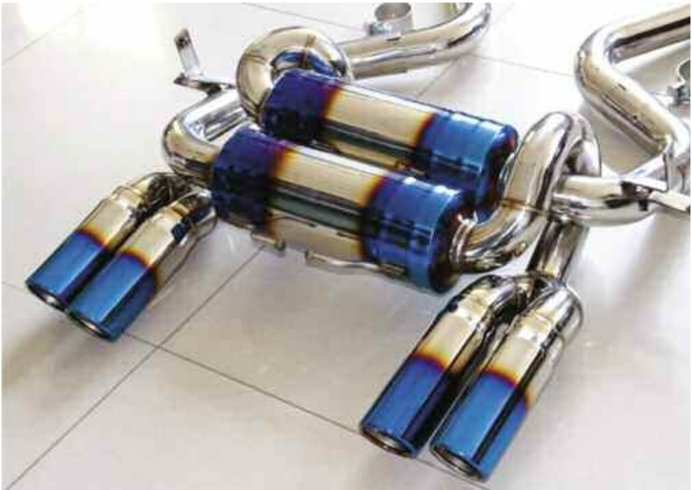
El sistema posee entre otros componentes, de acuerdo a las características del motor, catalizadores, silenciadores, cámaras de expansión y resonancia.
