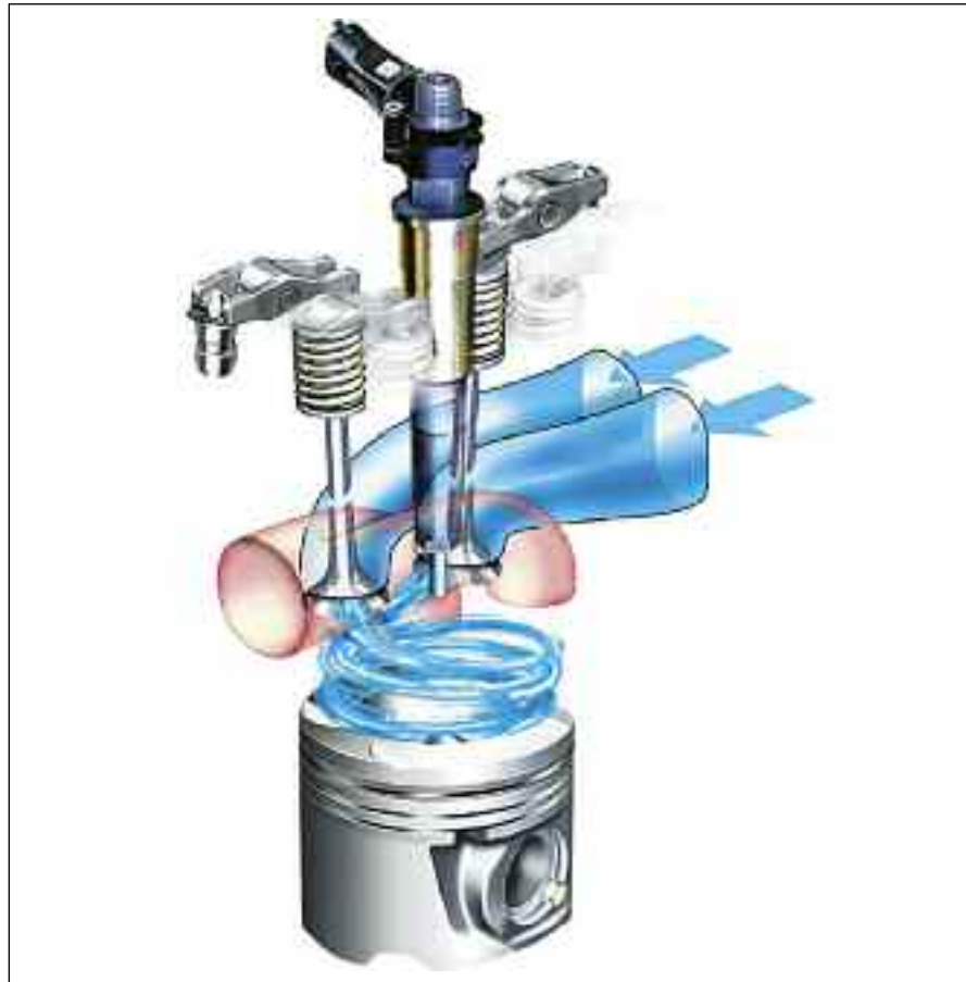
Se busca reducir el conocido efecto Swirl en la cámara de combustión, para disminuir las pérdidas por energía cinética y las transferencias térmicas a las paredes.
