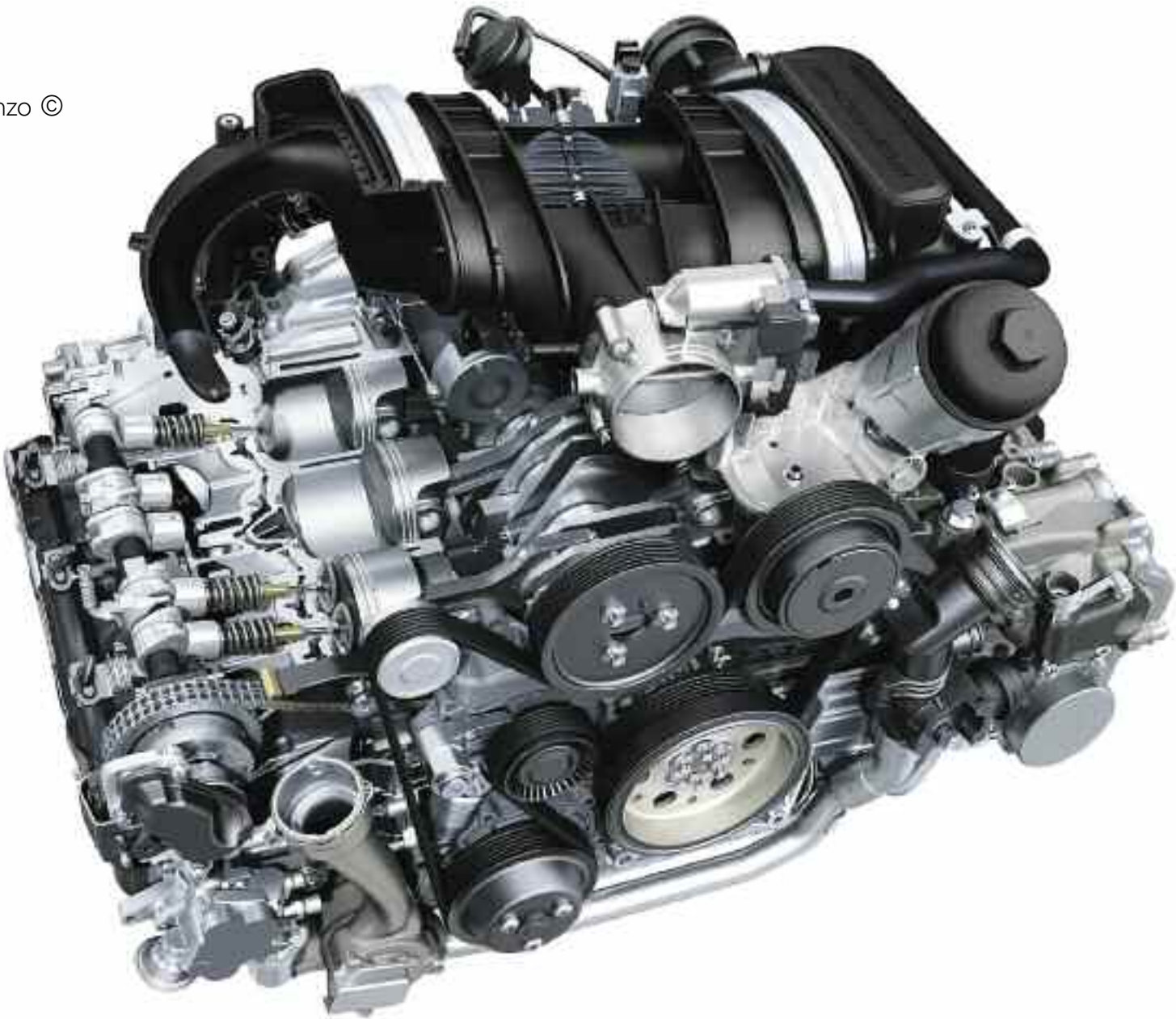
Corte parcial de un motor de 6 cilindros opuestos con inyección directa de nafta/gasolina, de 3,8 litros de cilindrada, con una potencia de 400 CV. a 7.400 rpm- Porsche.
