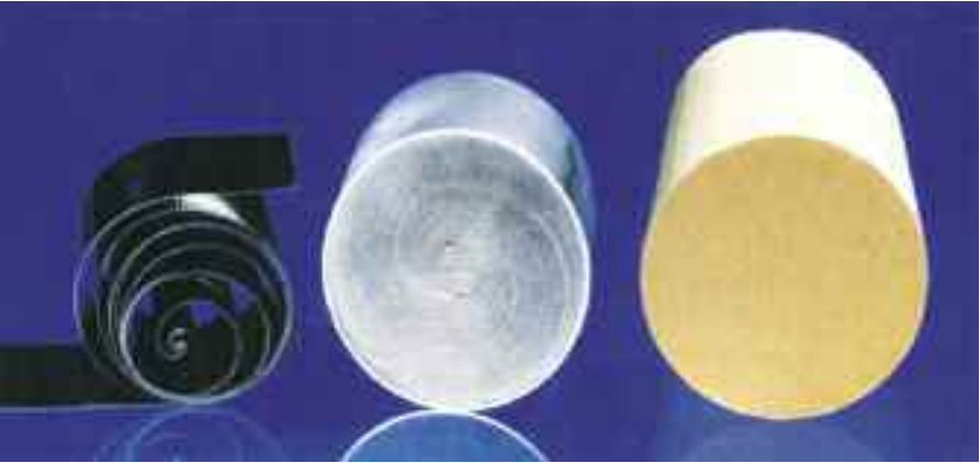
Monolitos cerámico y metálico; las características del motor determina el material y el volumen del convertidor catalítico.
