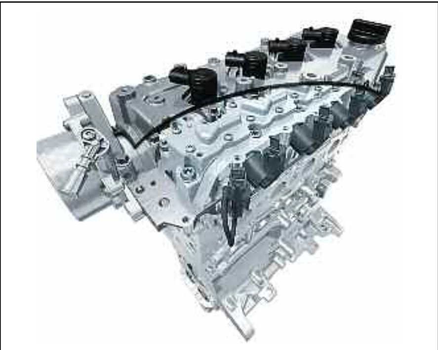
Multiair sistema de distribución variable desarrollado por Fiat, del tipo hidráulico, que varía la alza, la duración y el momento de apertura de las válvulas de admisión.
