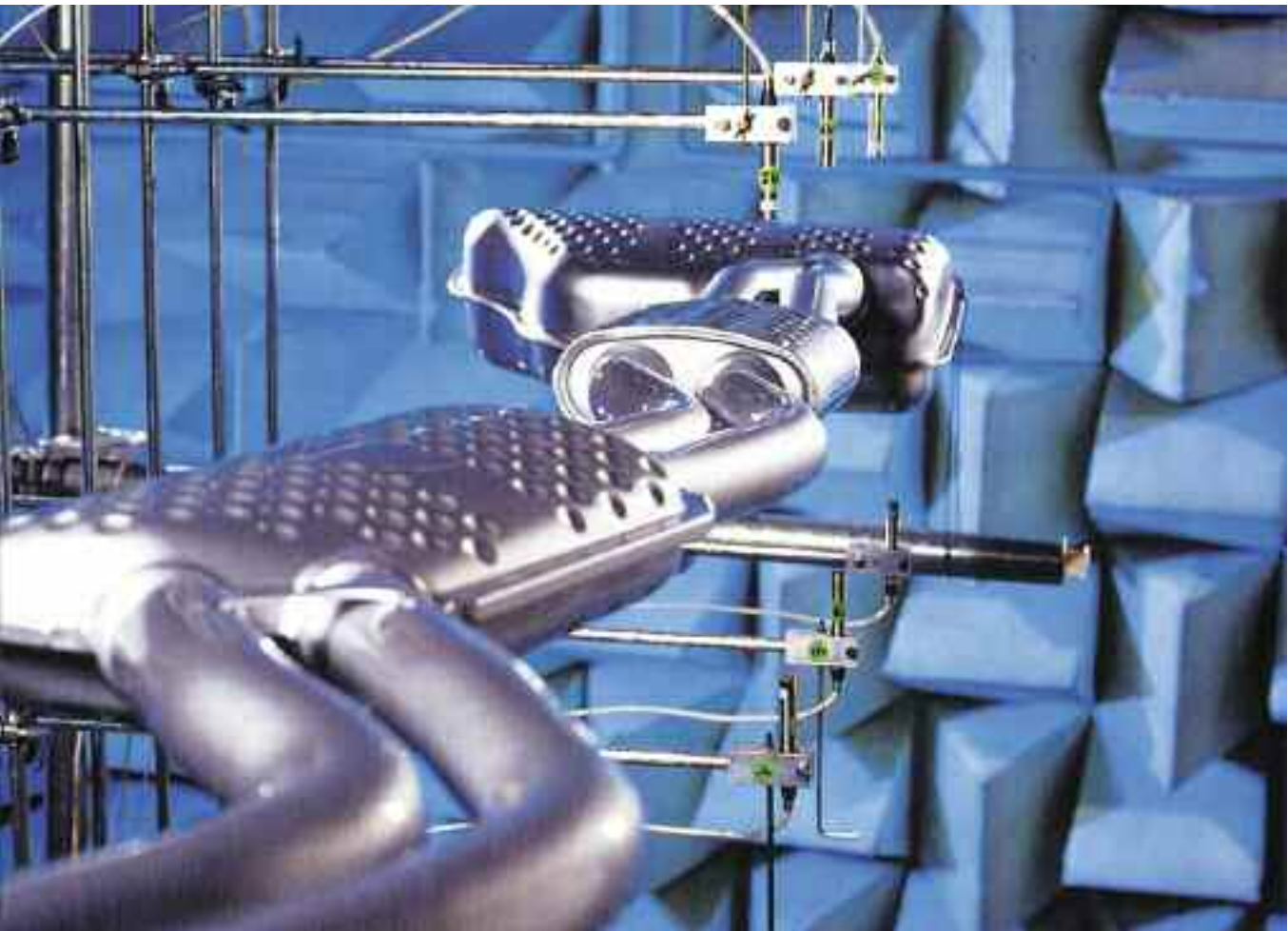
Medición con instrumentos de la frecuencia sonora en hertz, en función de la sensibilidad relativa en decibeles.
