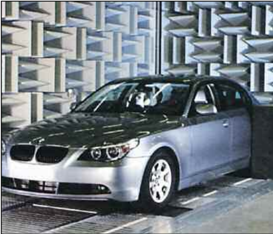
Ensayos del sistema de escape sobre el automóvil, en banco de pruebas de rodillos, en sala anecoica- Investigación & Desarrollo.
