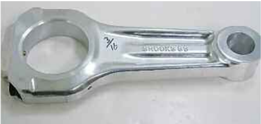
Entre los metales usados en la construcción de una biela moderna, esta el aluminio estampado.
