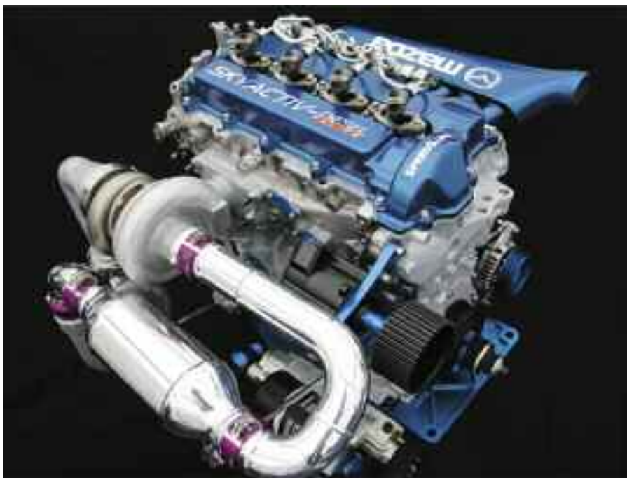
Motor de alto rendimiento de ciclo Diesel turbo -intercooler-. Mazda SkyActiv.
