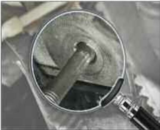
Fig. 2: El espárrago está roscado correctamente.
