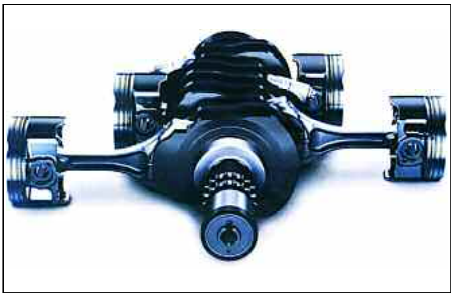
Parte rotativa / alternativa del motor Subaru boxer, de 4 cilindros; cigüeñal, bielas y pistones.
