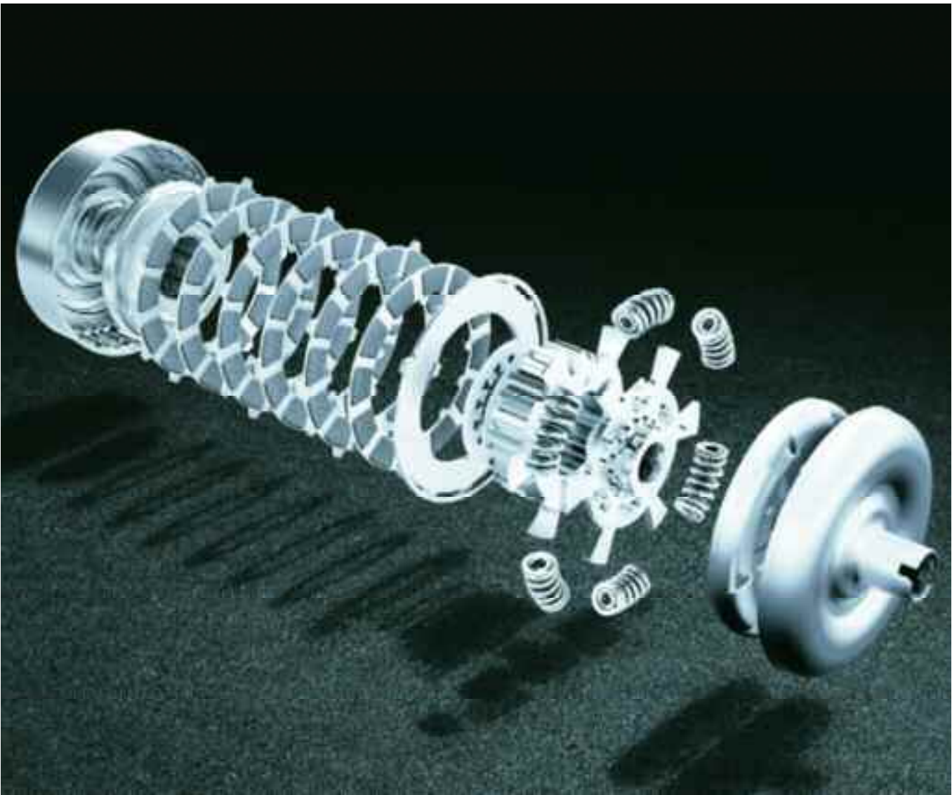
Buscando la supresión -para mejorar el rendimiento de la caja automática- del conocido “convertidor de par”, fue utilizado el embrague de discos múltiples denominado MCT- M. Benz.
