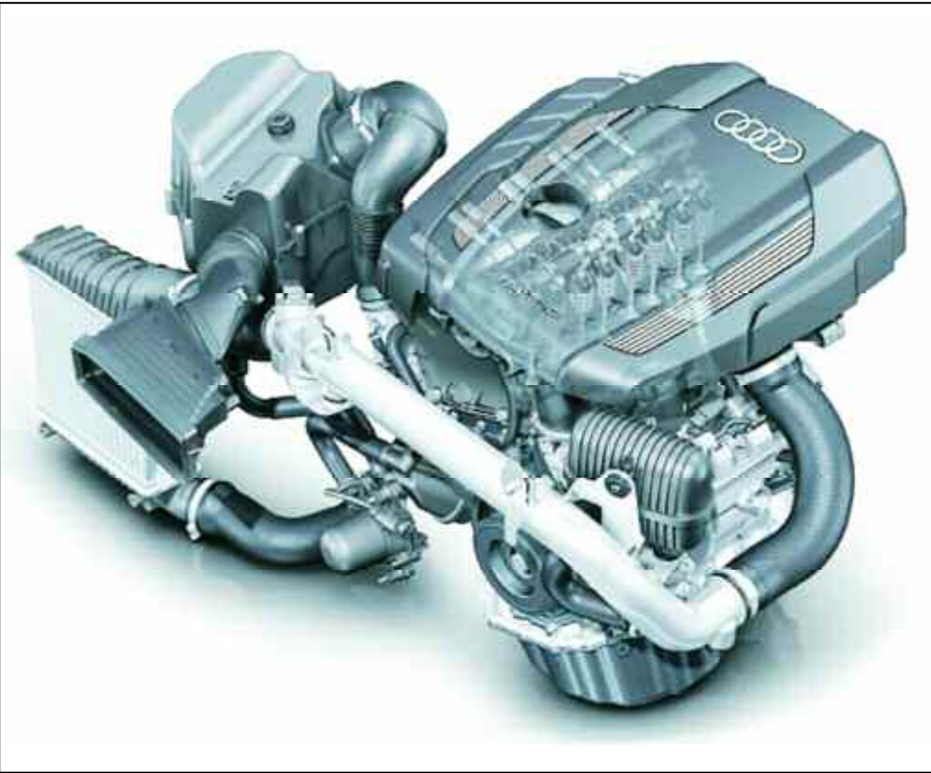
Actualmente, se está optimizando la preparación de motores térmicos para funcionar con tecnología híbrida, combinados con uno o varios motores eléctricos-Motor Audi 2.0 TFSI Hybrid.
