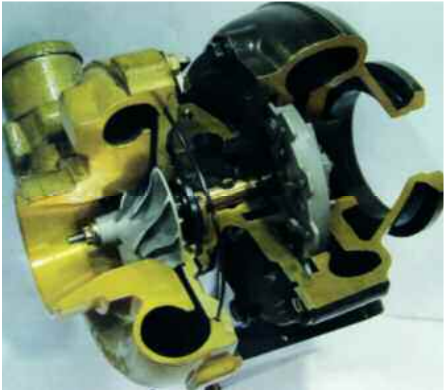
Corte parcial de un turbo TGV. (de geometría variable) o también denominado VNT (Variable Nozzle Turbine)- Garrett.
