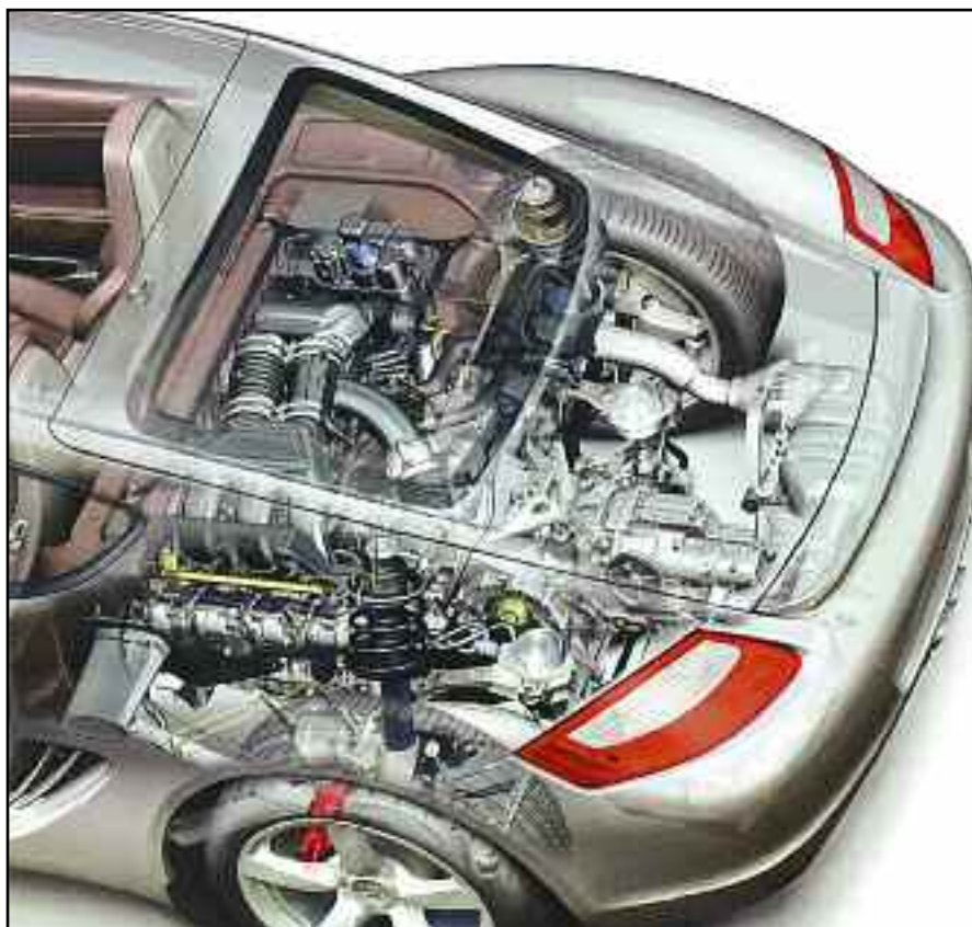
Motor boxer montado sobre el Porsche Cayman, sobre una base del 6 cilindros opuestos de 3.4 litros, la relación de compresión es de 11 a 1, la potencia de 295 CV. a 6.250 rpm y el par motor de 340 Nm. a 4400/6.000 rpm. Posee un llenado óptimo que garantiza las mejores prestaciones, mejorando además el rendimiento y el consumo.
