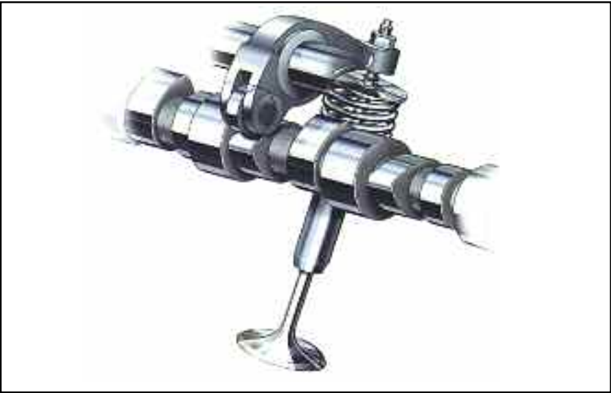
Detalle de Simple árbol de levas a la cabeza, con balancín a rodillo – Peugeot.
