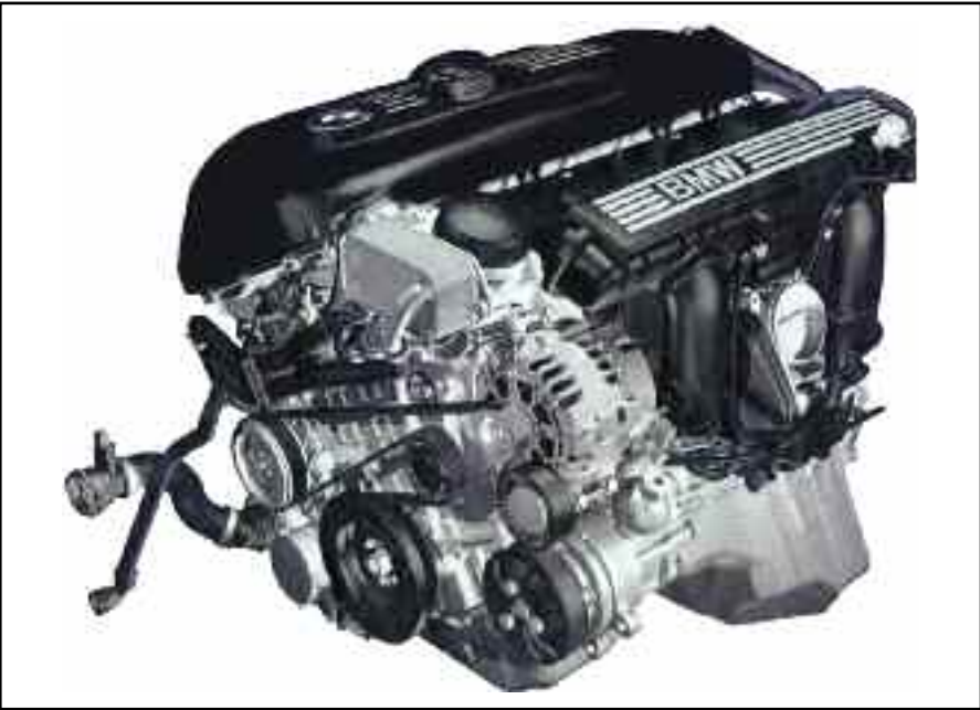
El nuevo motor de 6 cilindros en línea, con block cilindro construido en “Compound” de magnesio-aluminio, sistema de distribución Valvetronic II (comando de las válvulas de admisión), sistema VANOS de desfase variable de las levas, entre otras características.
