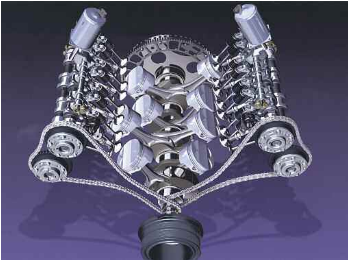
Parte alternativa/rotativa del motor V8 de 3.6 litros, y accionamiento por cadena del sistema de distribución de doble árbol de levas a la cabeza por cada banco de cilindros. Posee 32 válvulas y tecnología Bi-Vanos con Valvetronic – BMW.
