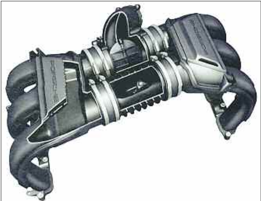
Sistema de admisión de aire variable- para todas las etapas - se trata de una gran caja, equipada de mariposas activas que permiten modificar el pasaje de aire para todos los regímenes. Cuando la mariposa de un costado se cierra, los dos bancos de cilindros se alimentan en forma separada, y el motor funciona un poco como un “doble 3 cilindros”. El efecto sonoro es de importancia en la admisión del motor.
