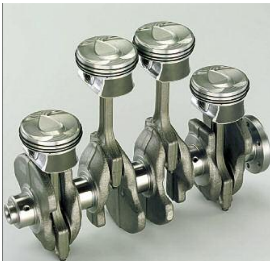
Componentes del conjunto rotativo-alternativo (cigüeñal, bielas y pistones), del motor naftero de inyección directa y turbo.
