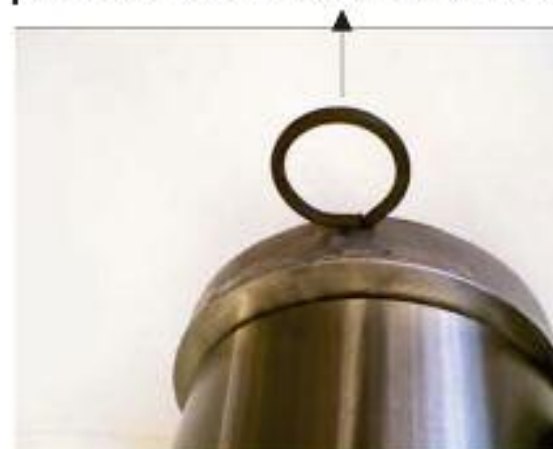
Fig. 3 Variante 2 - Extraer el pasador tras montar la correa
