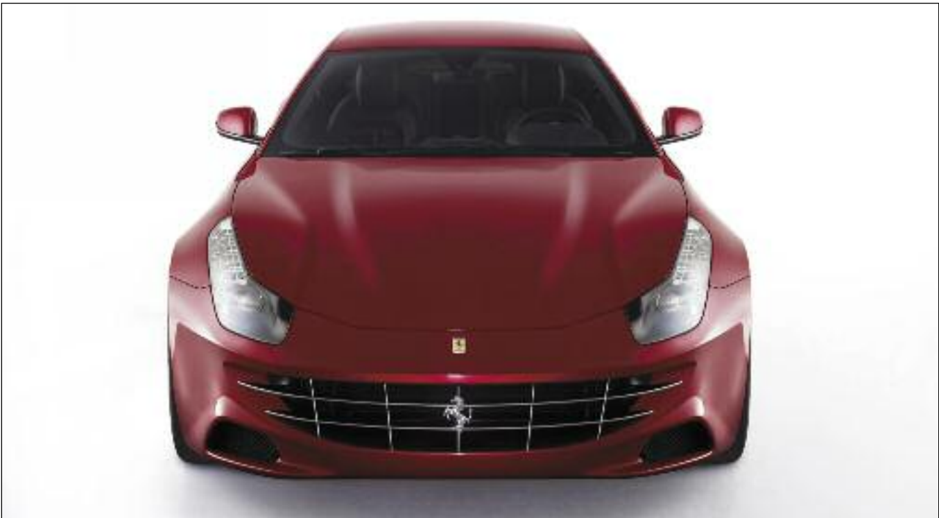
La Ferrari FF equipada con un motor V12 de 6.262cc de inyección directa que desarrolla 660 CV a 8.000 r.p.m.
