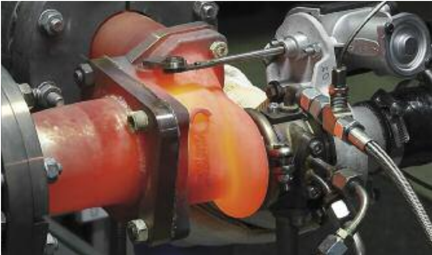
Turbo al rojo ceniza en el banco de ensayos - Investigación y Desarrollo - Borg Warner.
