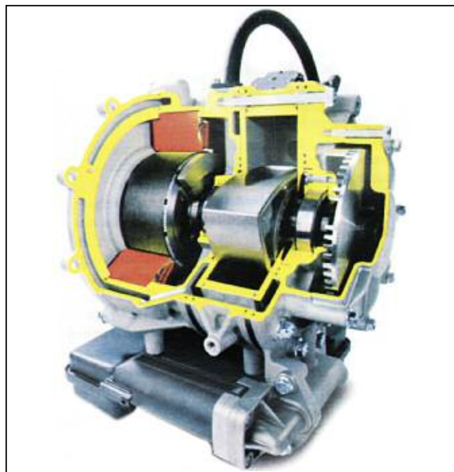
La firma austriaca AVL investiga sobre el motor Wankel, gracias al aporte actualizado de la electrónica, con el fin de desarrollar un motogenerador, para recargar la batería de un auto eléctrico.
