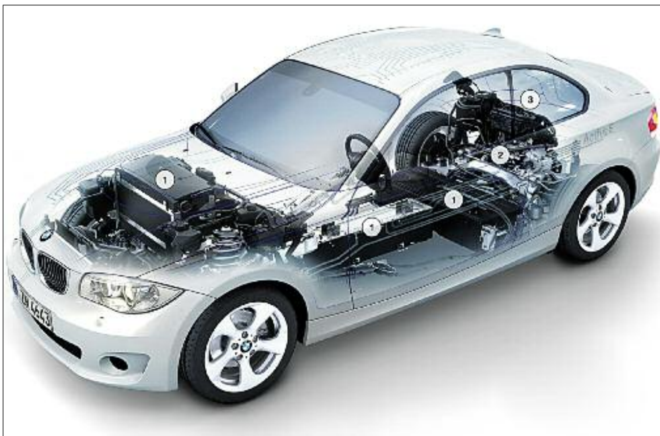
Componentes eléctricos principales del BMW Concept ActiveE: 1-Paquetes de batería de iones de litio. 2-Motor eléctrico. 3-Electrónica de potencia.
