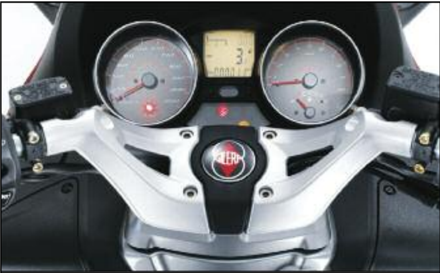
Un cuadro de mandos sencillo pero a la vez completo, compuesto por dos esferas (velocidad y RPM) y un display digital en el que muestra la temperatura, los parciales y el nivel de nafta/ gasolina.
