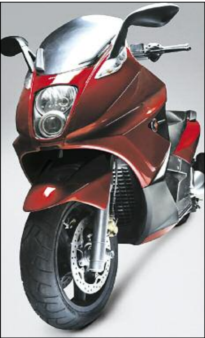
La altura del parabrisas se regular mediante un sencillo botón situado en la piña derecha, obteniendo así una mayor protección aerodinámica según el recorrido a realizar.
