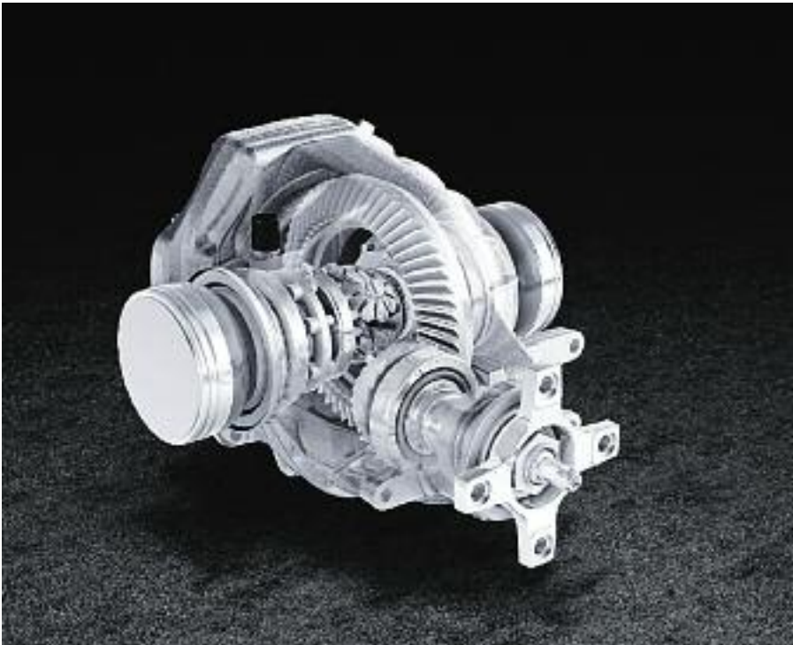
Diferencial autobloqueante cortado parcialmente, desarrollado por Mercedes Benz, para su modelo SL 63 AMG.
