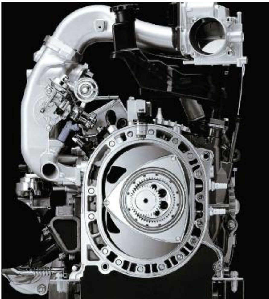
El Mazda RX-8 Hydrogen RE utiliza un motor rotativo Wankel.
