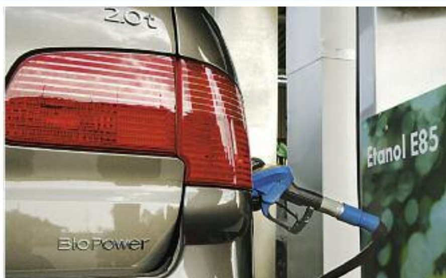
Surtidor de carga de "etanol E85". (mezcla del 85 por ciento de bio-etanol y del 15 por ciento de nafta/gasolina).-SAAB.
