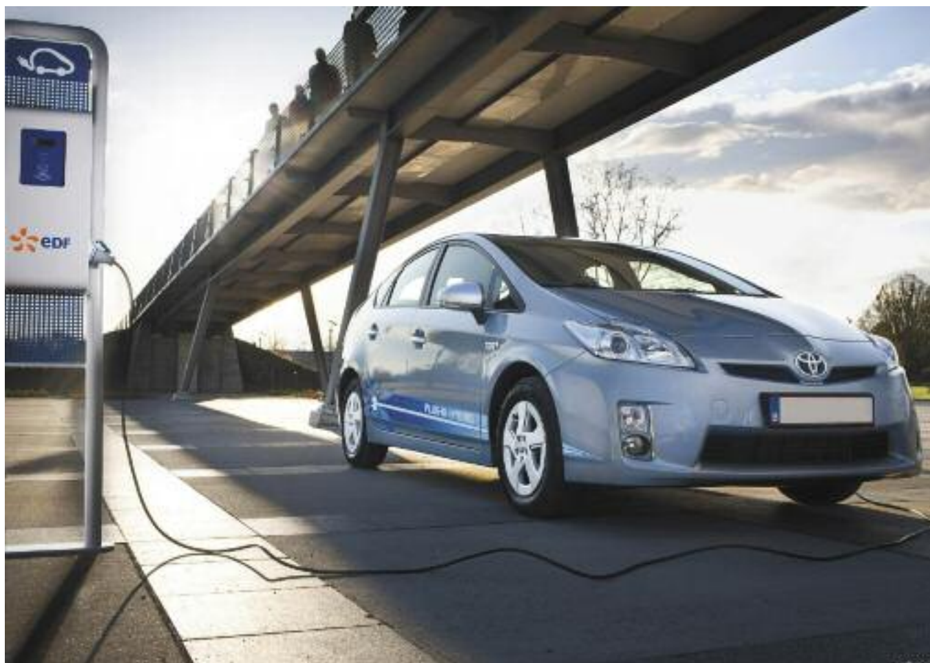
La batería de Ion-litio, se carga en 90 minutos a través de la red eléctrica domiciliaria.
