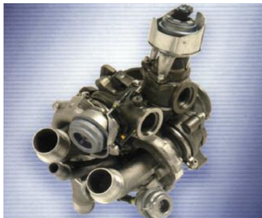
Sistema de sobrealimentación, con ‘doble turbo secuencial paralelo’, para un motor Diesel de 4 cilindros en línea. Un turbo pequeño – de inercia reducida – se utiliza en los bajos regímenes, el mismo es reemplazado a las 2.700 rpm por otro turbo de las mismas dimensiones, todo controlado electrónicamente – Ford/Grupo PSA/Honeywell.
