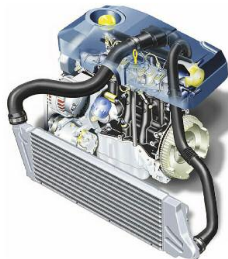
Motor Diesel de 1,5 litros de 100 CV con turbo de geometría variable (TGV) e intercooler, sistema de inyección directa “Common rail” de tipo esférico, y sistema anticontaminación – Renault.
