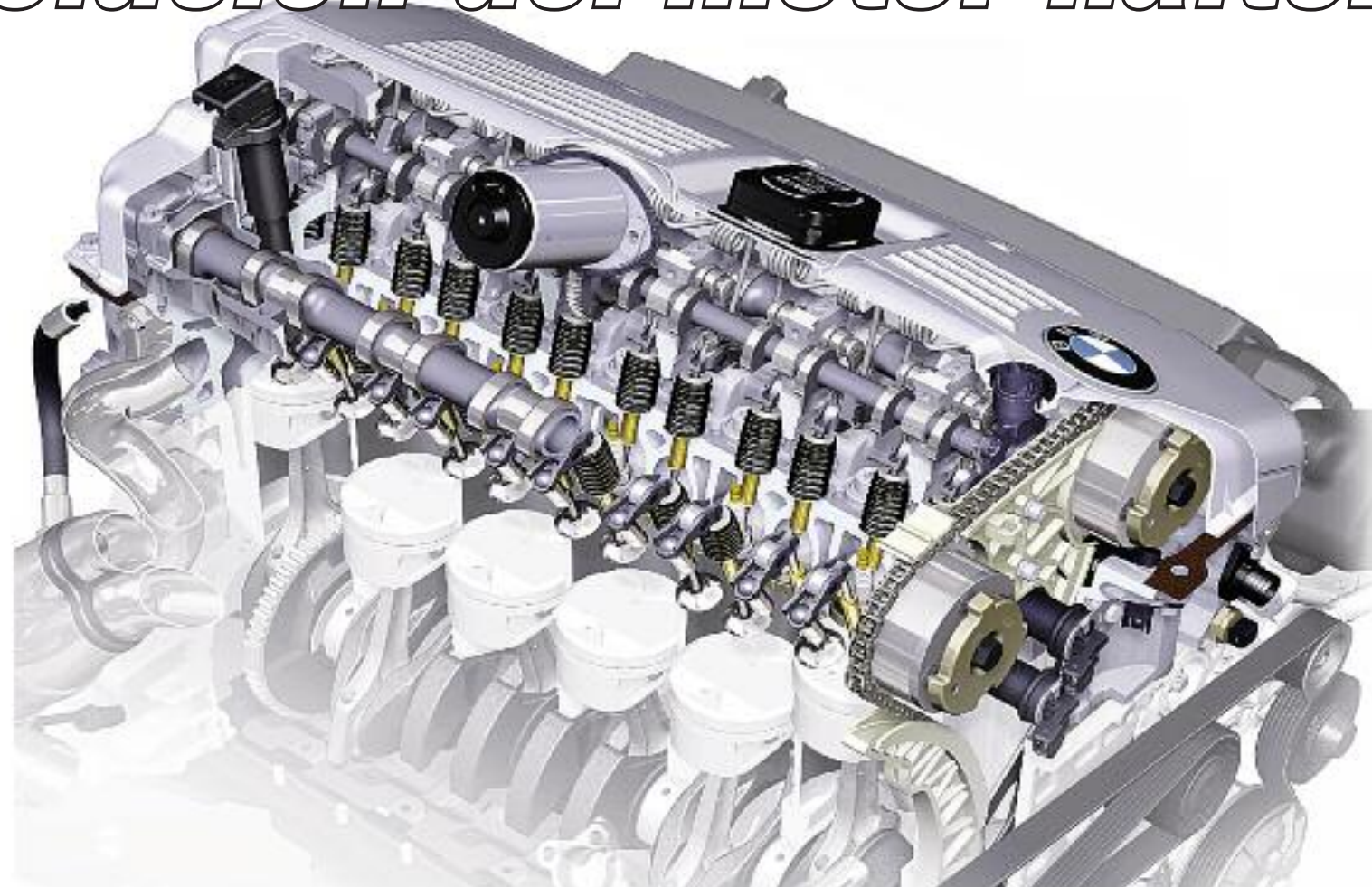
Nuevo motor de ciclo Otto (nafta/gasolina) de 6 cilindros en línea, con sistema de distribución variable Valvetronic y VANOS – BMW.
