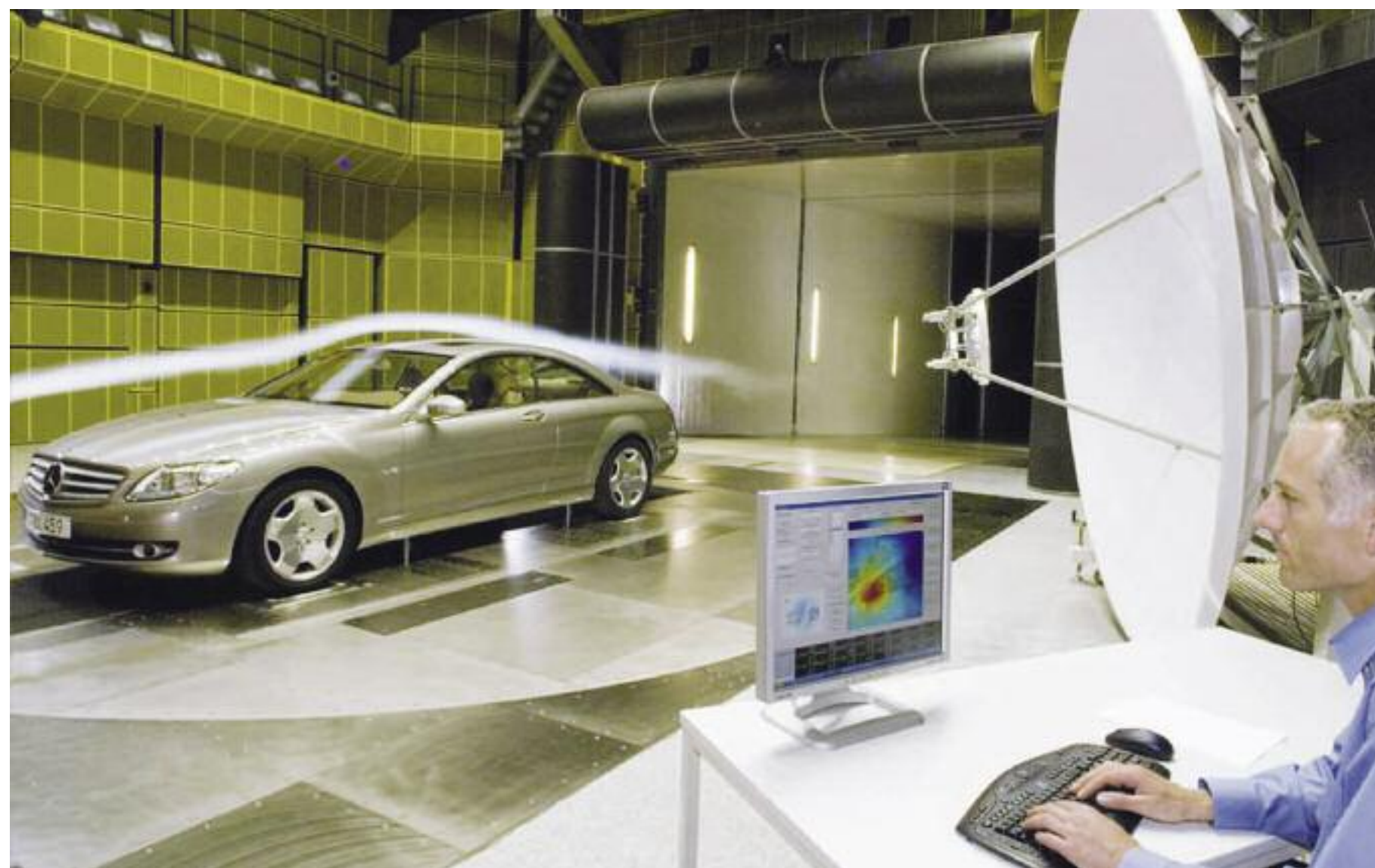
Estudio del flujo de aire, en el túnel aerodinámico de Mercedes Benz.
