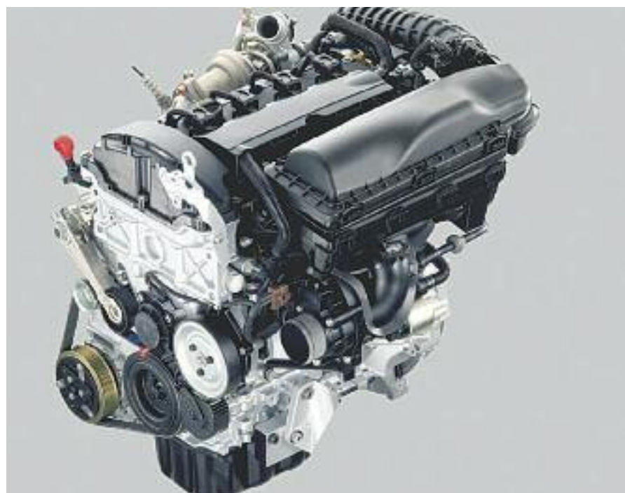
Vista exterior del motor de 4 cilindros en línea (‘downsizing’), con inyección directa de nafta/gasolina, turbosobrealimentado, que entrega 143 CV de potencia – BMW/PSA.
