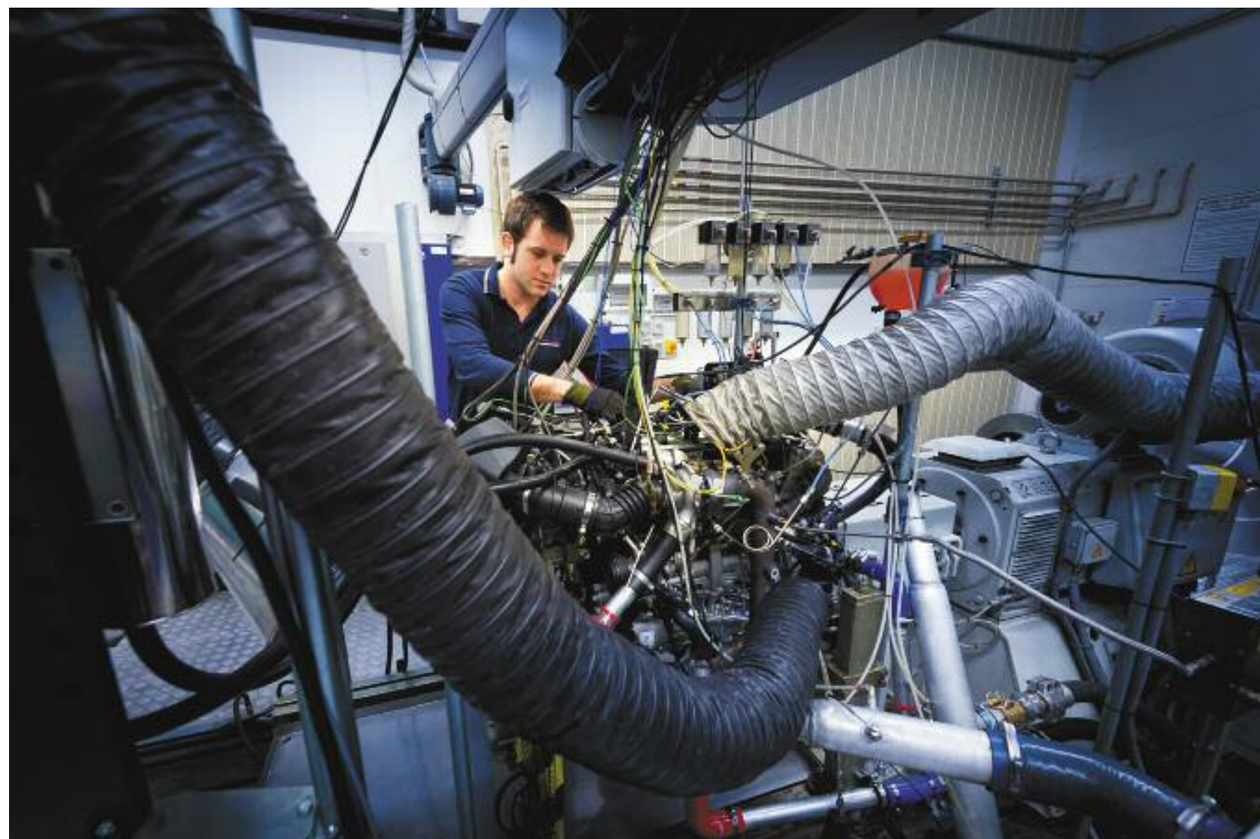
Motor Diesel sometido a ensayos en banco de pruebas dinámico.- Opel
