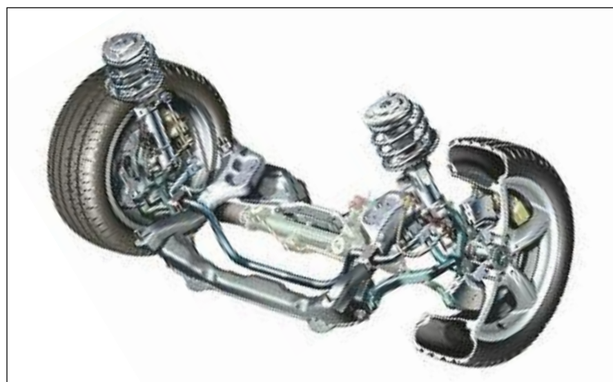
Sistema de suspensión delantera con dirección asistida - M. Benz.
