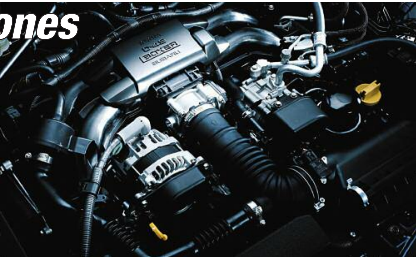
Motor D4S Boxer en el cofre, con inyección de nafta/gasolina doble (directa-indirecta) utilizado por el Subaru BRZ, y por el Toyota GT 86.
