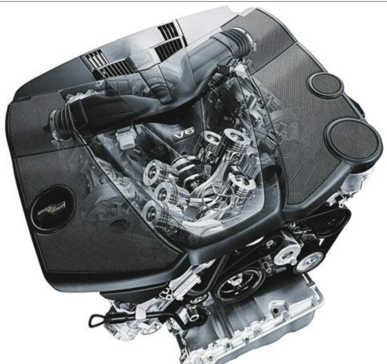
Motor V6 Diesel Mercedes Benz E Class en detalle.
