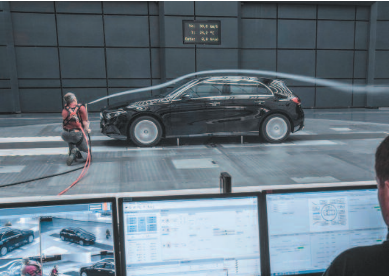
Túnel aerodinámico, estudiando al modelo A con humo parafínico e instrumental en cabina.- MBenz.
