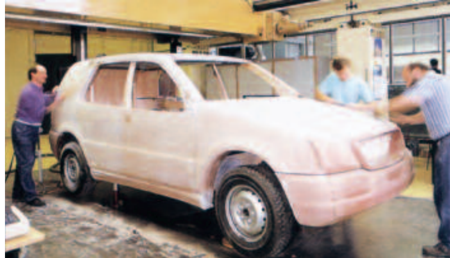
Modelo a escala natural de la M. Benz M-Class, realizado por los diseñadores en arcilla.
