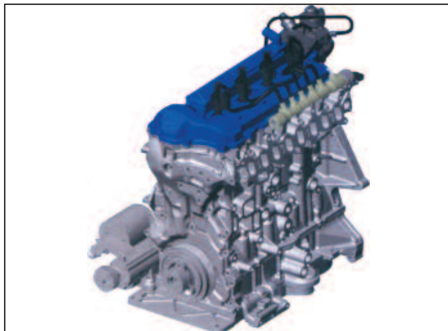
Debido a la baja relación de compresión, las presiones son menores, y por lo tanto se pueden construir los componentes más livianos.- Mazda.
