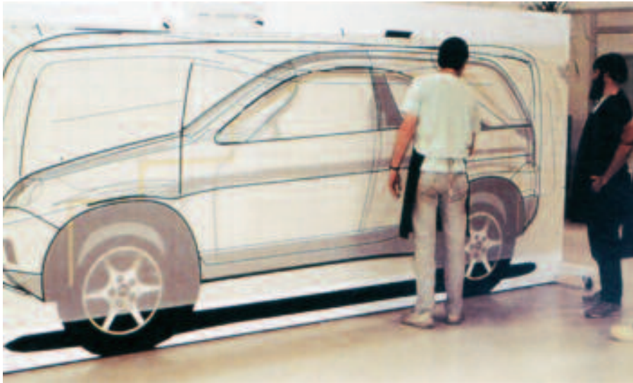
Corrección de un plano de perfil, de un modelo de dos puertas M-Class Concept car. - M.Benz.
