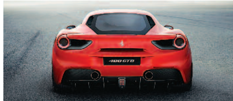
La mayor altura requerida para el difusor en la Ferrari 488 GTB, se logró mediante el reposicionamiento de los tubos de escape. Las luces traseras LED circulares también han sido rediseñadas.
