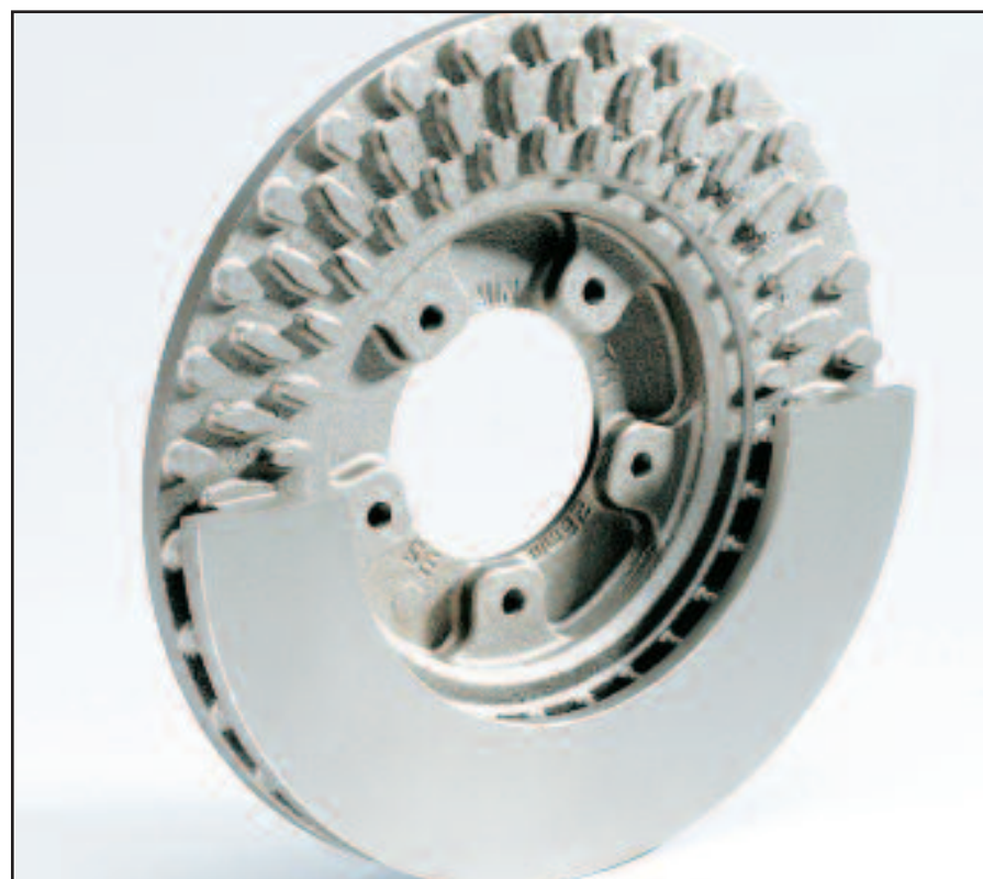
Cuando el calor disperso al frenar aumenta, las superficies de un disco sólido no alcanzan; debido a ello se usan los discos ventilados.
