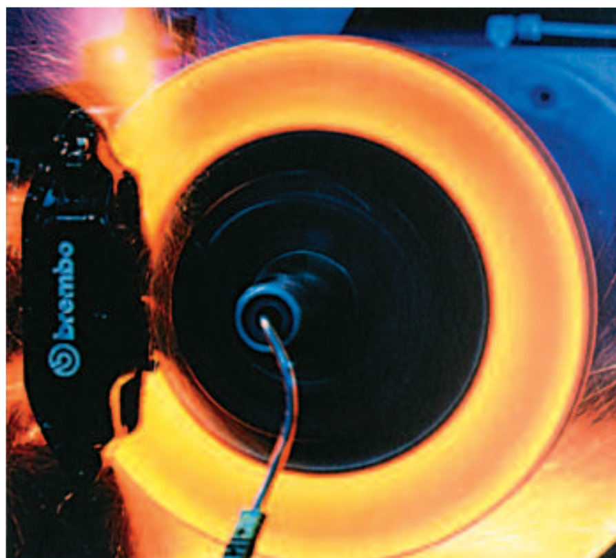
Ensayo de choque térmico en banco dinamométrico – Brembo.
