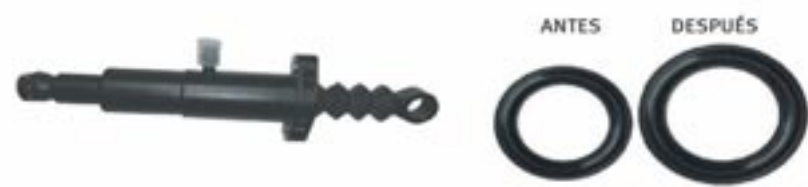
Fig. 1: Cilindro maestro LuK 511 0326 10 y comparativo de tamaño entre una vedación, antes y después de la contaminación.
