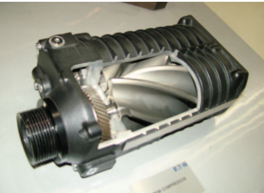
Corte de un compresor mecánico del tipo a tornillo accionado por el cigüeñal - Eaton.
