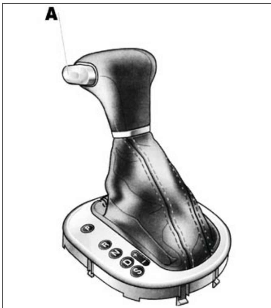
Palanca selectora de accionamiento de una caja automática, con tecla de desbloqueo (A): P - Parking; R - Reversa; N - Neutral; D - Drive, S - Sport.
