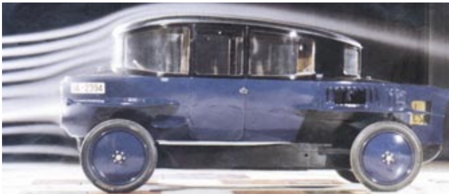
El conocido automóvil "Rumpler" de 1922, denominado gota de agua, fue recientemente restaurado y probado aerodinámicamente – Volkswagen AG.
