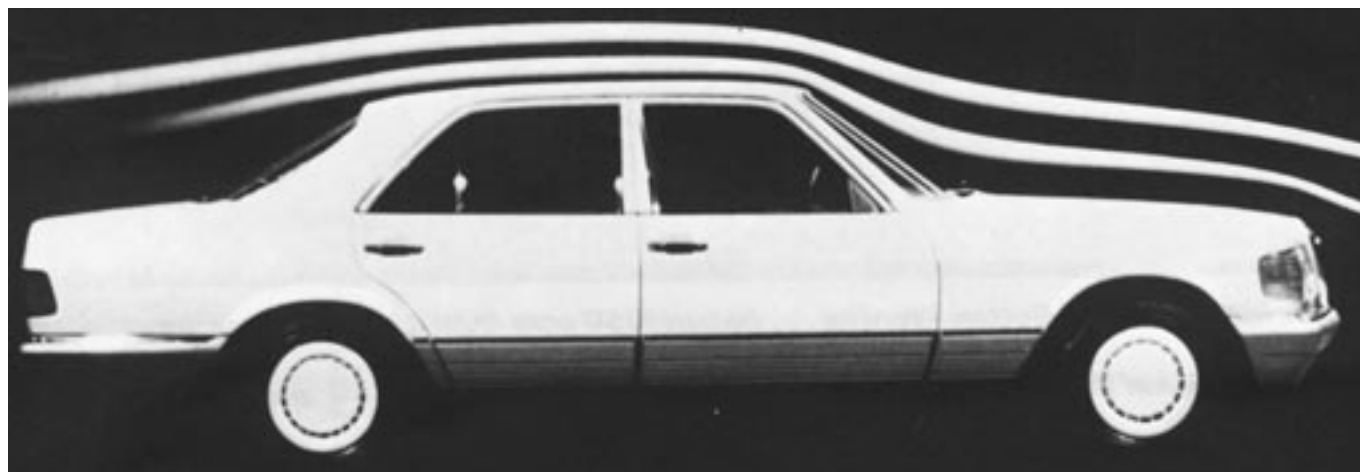
Pruebas con humo químico en túnel aerodinámico de un modelo Mercedes Benz.
