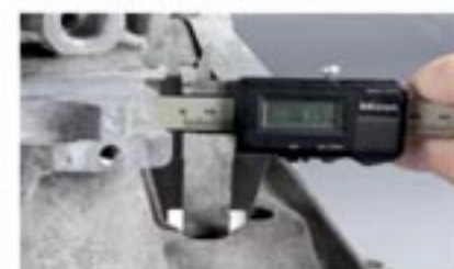
Fig. 2: Si el diámetro es menor de 21 mm, se deben ampliar los orificios con un taladro hasta que alcancen un mínimo de 21 mm y un máximo de 24 mm.
