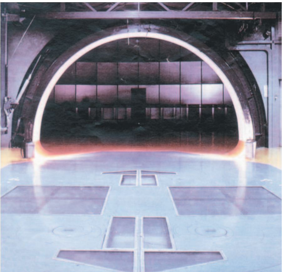
Túnel de viento y detalle en el suelo de su balanza, que es el mecanismo que hace que los resultados sean fieles a la realidad –Pininfarina.
