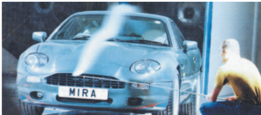
Estudios aerodinámicos desarrollados en túnel de viento, sobre un Aston Martin DB7, perteneciente al Mira de Inglaterra – Motor Industrie Research Association.
